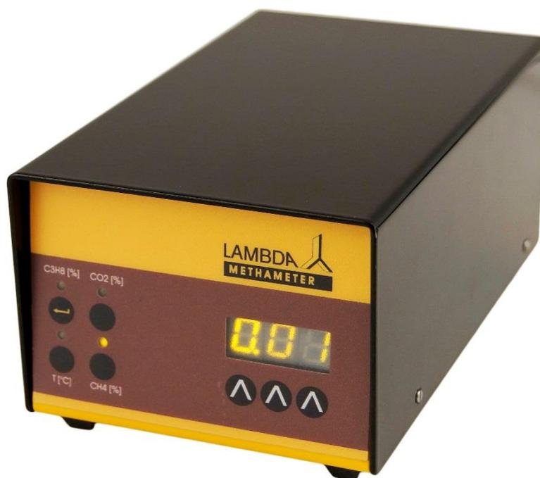
METHAMETER mesure la **concentration de  $\text{CH}_4$**  dans les gaz de sortie.
